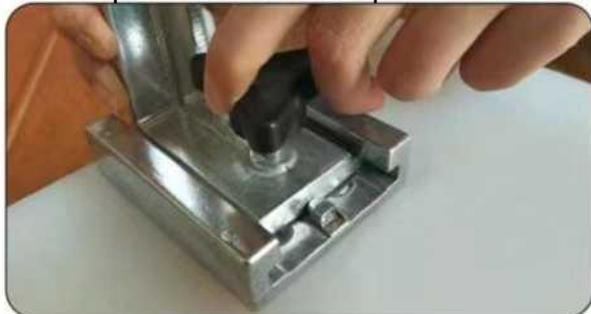
3. Вставьте нижнюю часть ножи в монтажное основание и соедините их болтом с треугольной ручкой.
