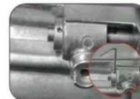
5. Снимите пластину лезвия после извлечения стопорного штифта.
